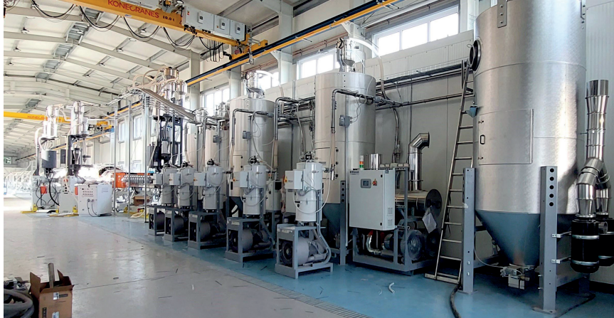
Gruppo di estrusione (sullo sfondo) ed essiccatori durante il collaudo della linea.
