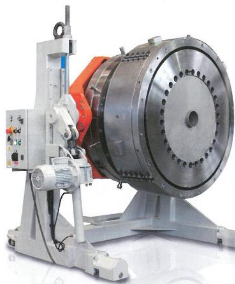
Uma cabeça da gama Venus, desenvolvida pela Tecnomatic para a extrusão de tubos de grande diâmetro
